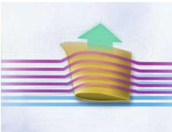
Penampang sayap pesawat dan diagram aliran angin di sekeliling sayap pesawat (gambar dari Boeing, Inc.)
